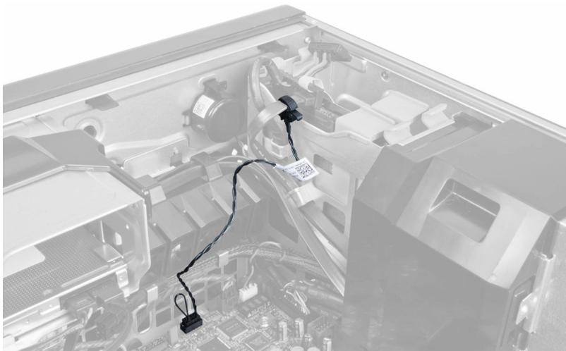
4. Desconecte o cabo do sensor térmico da HDD frontal da placa de sistema.
