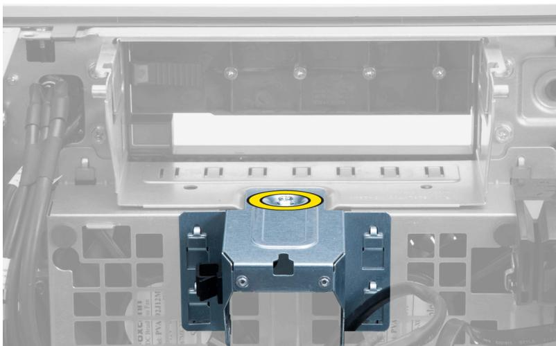
5. Pressione as travas na outra extremidade da placa metálica para liberá-la.
