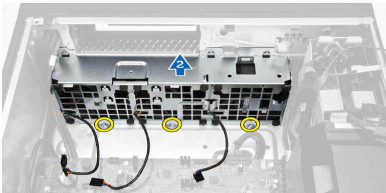
10. Retire os pinos de borracha para remover os ventiladores do sistema do conjunto de ventilador do sistema.
