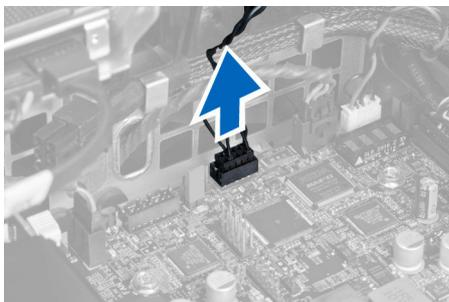
5. Libere a trava que prende o sensor térmico da HDD. Aqui, o sensor térmico da HDD está conectado na unidade de disco rígido.
