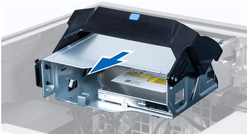
9. Remova os parafusos que prendem o compartimento da unidade óptica.
