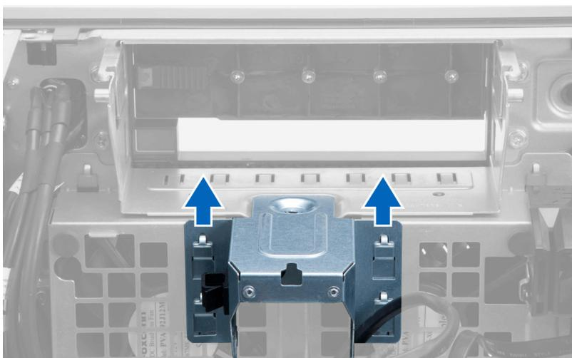
6. Retire a placa metálica do chassi.
