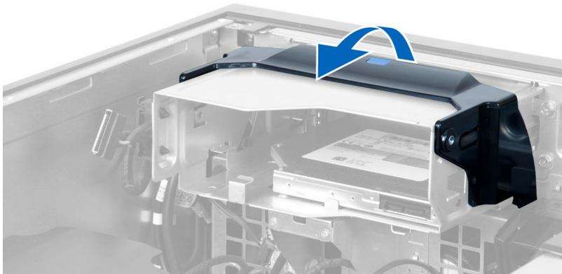
8. Segurando a trava de liberação, deslize o compartimento da unidade óptica para fora do compartimento.
