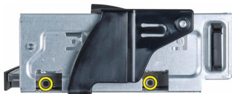
10. Remova os parafusos que prendem o compartimento da unidade óptica.
