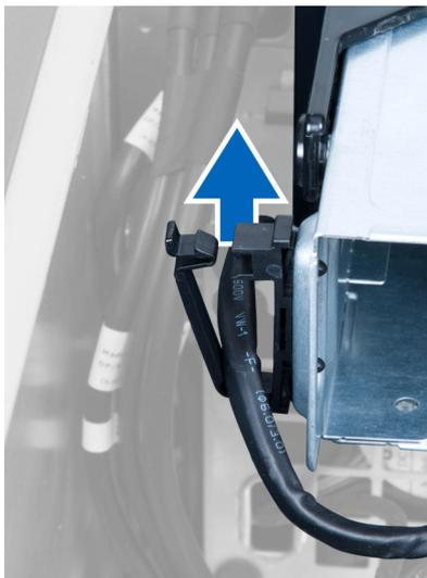
7. Levante a trava de liberação na parte superior do compartimento da unidade óptica.
