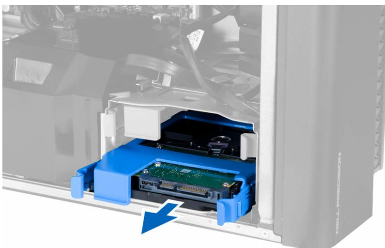
6. se um disco rígido de 2,5 polegadas estiver instalado, remova os parafusos e erga o disco rígido para removê-lo do respectivo receptáculo.
