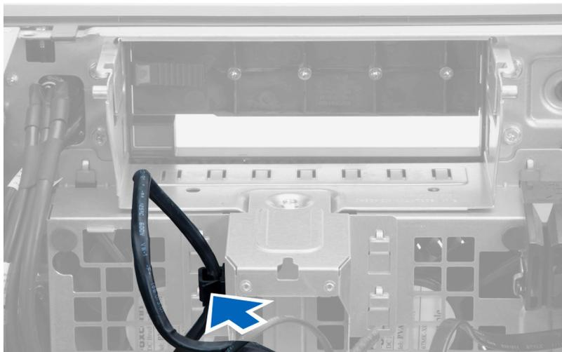
4. Remova o parafuso que prende a placa metálica ao ventilador do sistema.
