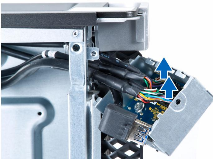
6. Remova os parafusos que prendem o painel de E/S no compartimento do painel de E/S.
